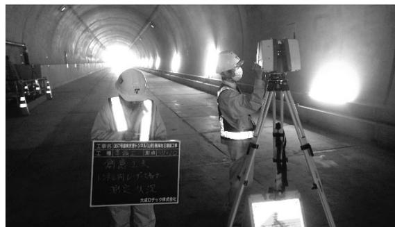
図-3 TLSによる計測状況
