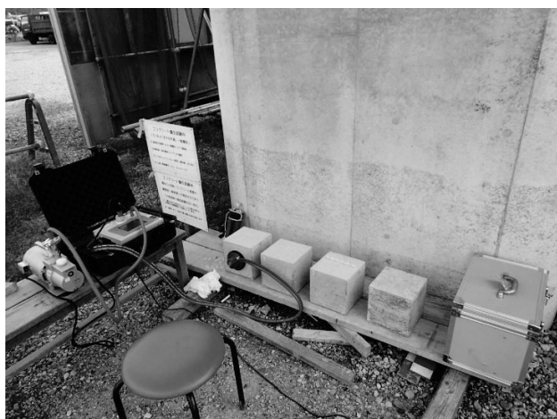
図-4 透気試験状況
