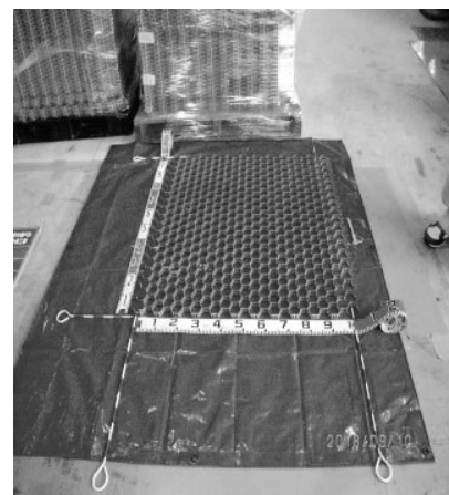
図-1 鋼製六角パネル
