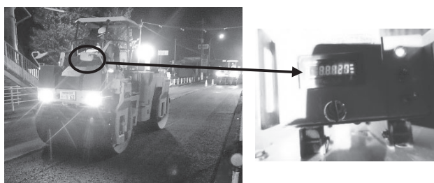
図-5 振動ローラ・温度表示機
