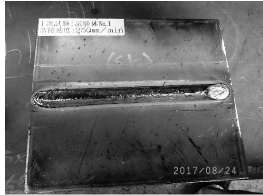
図-4 熱影響1次試験の試験体の溶接状況
