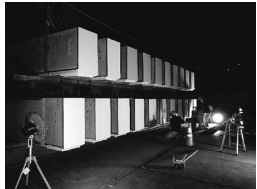
図-3 コンクリート塗装状況
