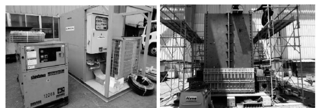
図-7 水温管理ユニットおよび施工試験供試体
