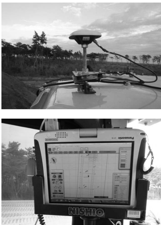
図-4 GPS 施工管理システム
