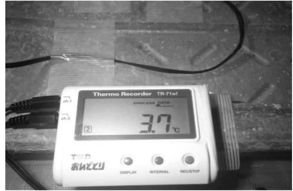
図-7 養生温度管理（1：養生内温度・2：外気温）
