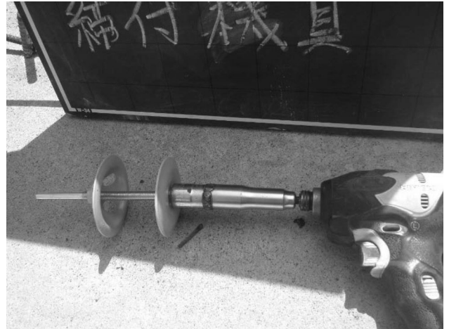
図-8 製作した残存型枠専用ボックスレンチ
