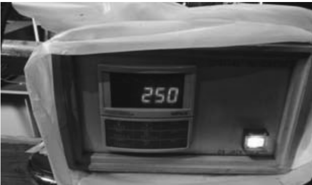
図-3 デジタル圧力メーター
