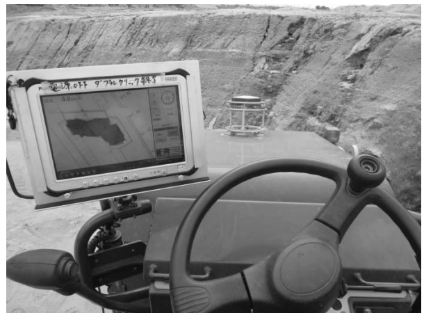
図-5 転圧管理システムモニター
