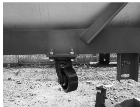
図-8 据付架台脚部に設置したキャスター
