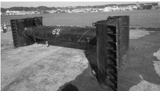
図-1 鋼管杭補強部材全景写真
