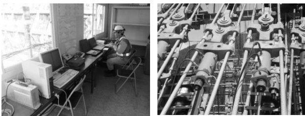
図-4 集中管理室とロードセル設置状況
