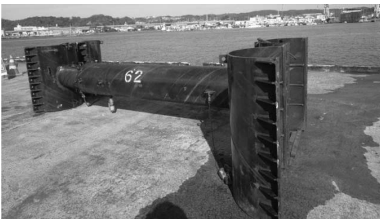
図-1 鋼管杭補強部材全景写真
