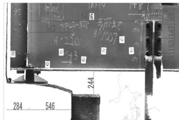
図-7 断面データを2D-CAD上で計測
