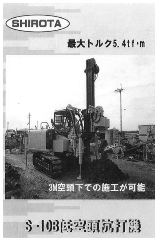
図-3 使用鋼管杭打設機械
