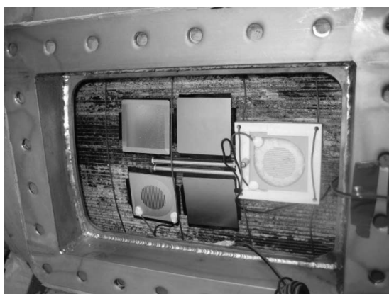
図-3 モニタリングカバー内のACMセンサ類
