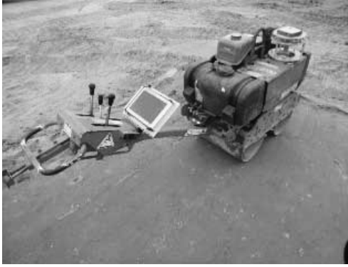
図-3 GNSS 締固めシステム付ローラー
