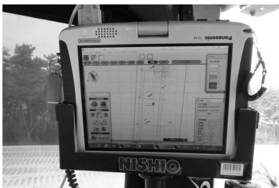
図-4 GPS 施工管理システム
