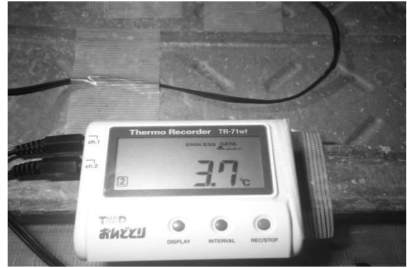
図-7 養生温度管理（1：養生内温度・2：外気温）
