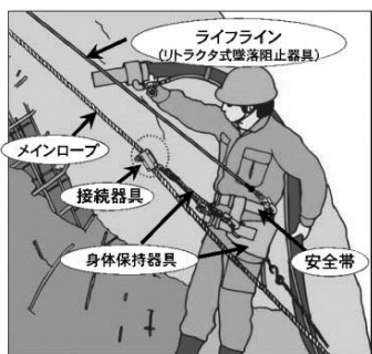
図-4 ロープ高所作業におけるライフライン
