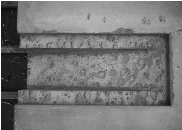
図-3 模擬試験体下面の気泡滞留状況
