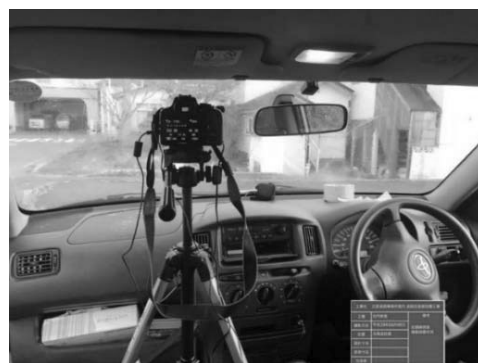
図-3 調査カメラ車載状況
