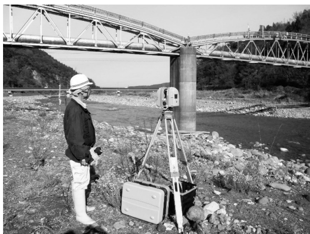
図-5 3Dレーザースキャナー測量状況
