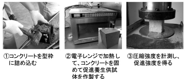
図-1 促進養生供試体の作製手順
