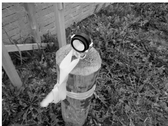
図-2 変位杭に取付けたプリズム
