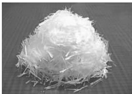
図-11 ポリプロピレン製短繊維
