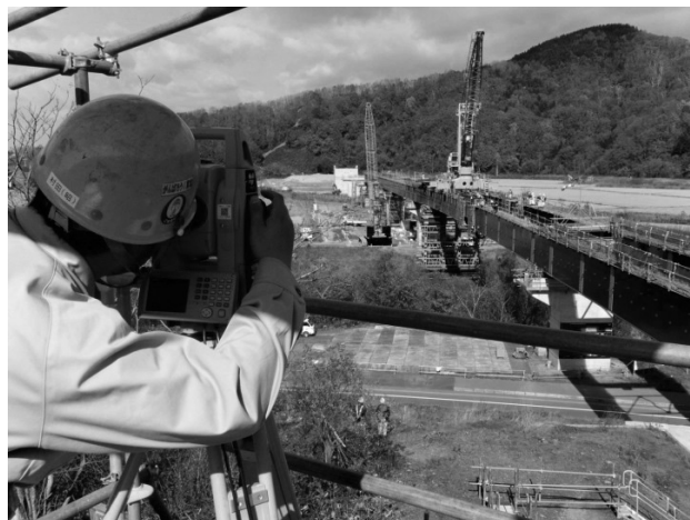
図-3 自動追尾型 TS による計測
