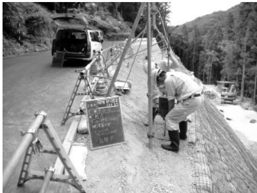
図-6 スウェーデン式サウンディング試験状況
