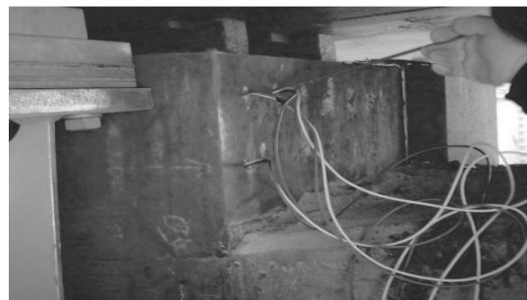
図-3 箱桁の桁下部カプセル配置
