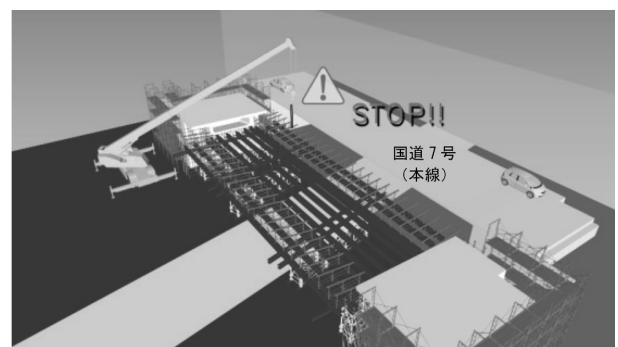
図-5 三次元CADによるクレーンの安全対策
