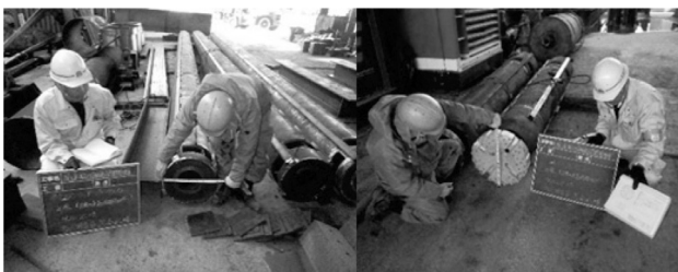
図-4 ハンマービット・ロッド工場検査
