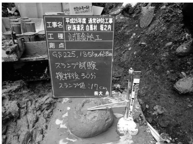
図-1 試験施工スランプ試験 (30分後)
