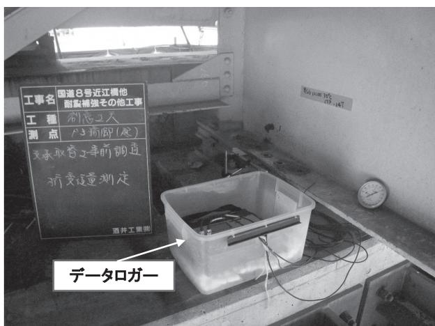
図-4 データロガー設置状況
