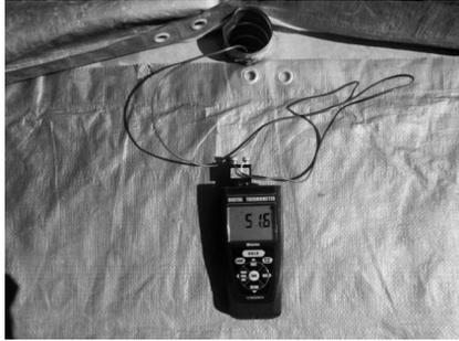
図-3 パイプ内温度測定状況
