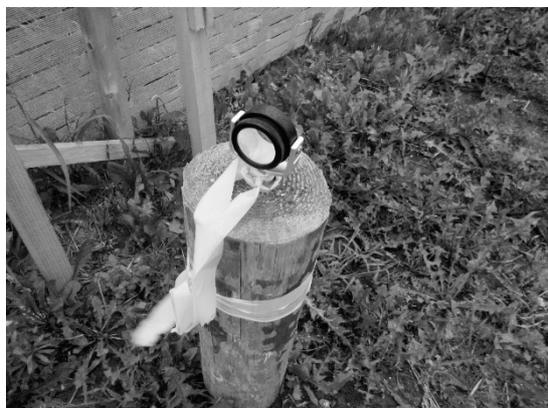
図-2 変位杭に取付けたプリズム
