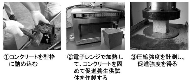
図-1 促進養生供試体の作製手順
