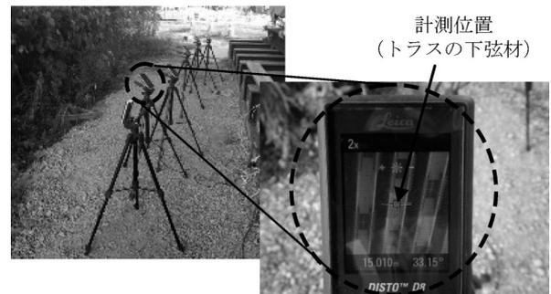
図-8 レーザー距離計設置状況
