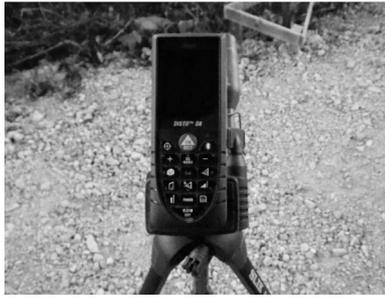
図-5 レーザー距離計
