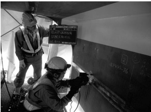
図-11 隅角部磁粉探傷検査実施
