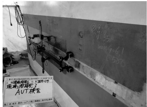
図-12 超音波自動探傷検査状況
