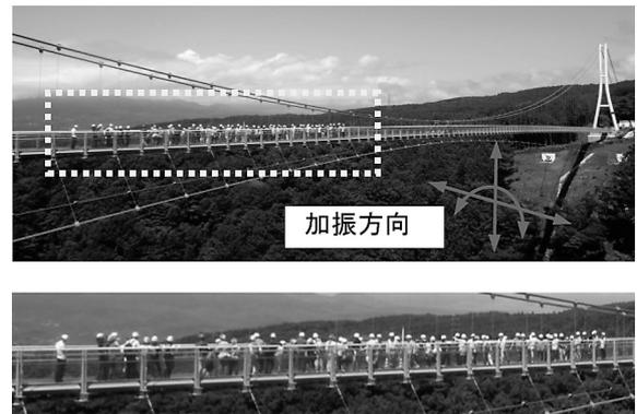
図-12 実橋振動試験状況
