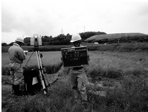
図-4 3次元レーザースキャナー状況
