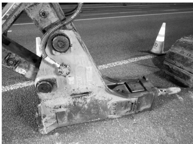
図-2 ①超低騒音型油圧ブレーカ
