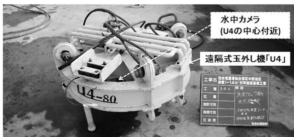
図-3 遠隔式玉外し機
