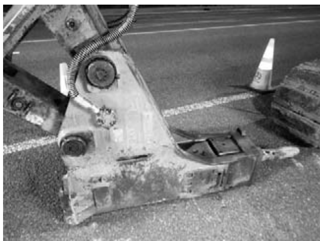
図-2 ①超低騒音型油圧ブレーカ
