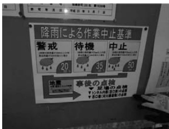
図-7 降雨による作業中止基準
