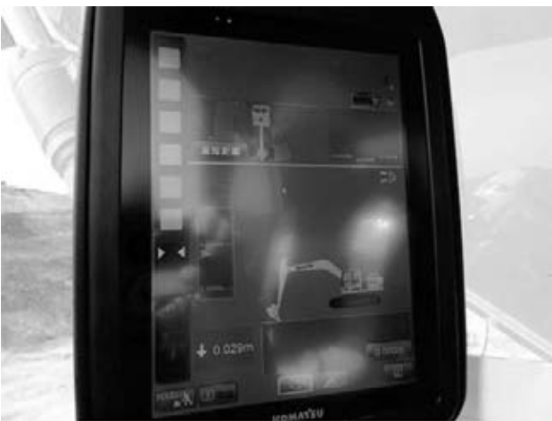
図-3 施工時搭載モニター表示状況
