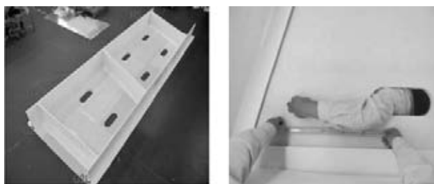
図-5 カバ- PL 実物大模型 (当初設計)
