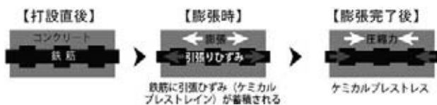
図-2 ケミカルプレストレスの概要
