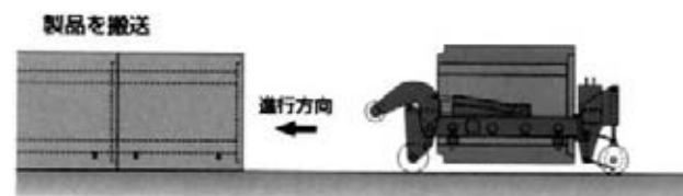
図-4 リフトローラー工法
