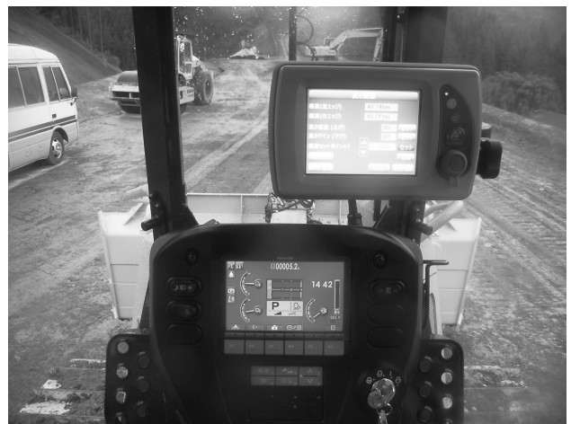
図-4 ブルドーザマシンコントロール
