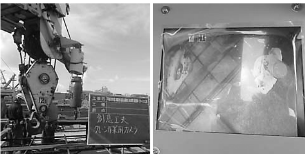
図-4 クレーン用カメラ（陸上）
