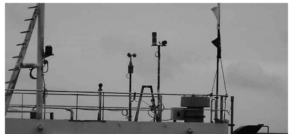
図-7 風速計設置
