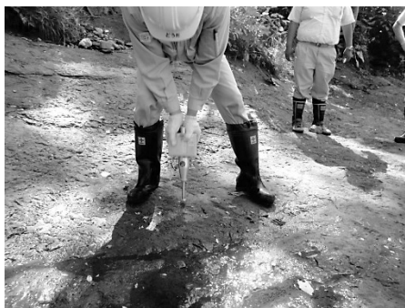
図-2 ロックシュミットハンマー試験
