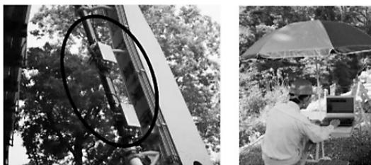
図-4 連続 RI 水分計による計測
