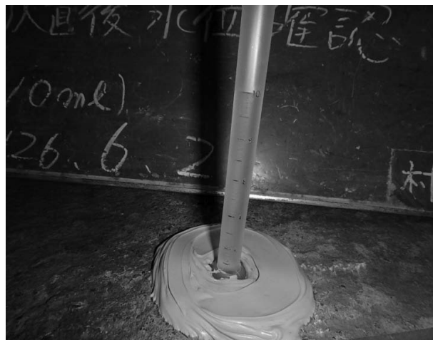
図-5 表面浸透試験
