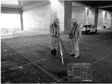
図-3 試験施工（キャスポルによる測定）
