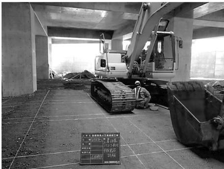
図-4 試験施工（平板載荷試験状況）
