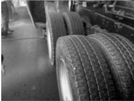
図-2 タイヤ付着抑制 As 乳剤使用
