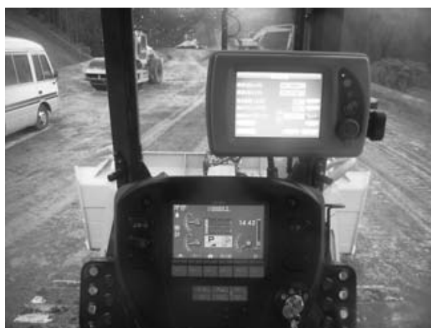
図-4 ブルドーザマシンコントロール
