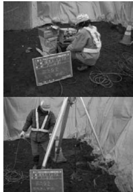
図-10 磁気探査測定状況
