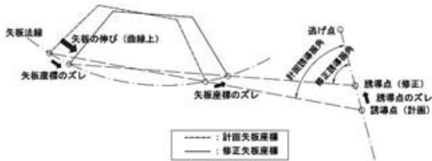
図-5 伸びによる誘導点の修正
