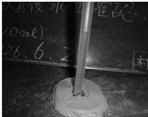
図-5 表面浸透試験
