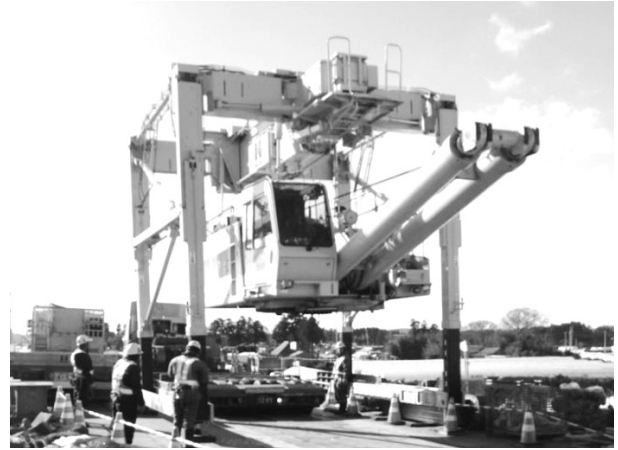
図-3 クレーン分解組立専用装置
