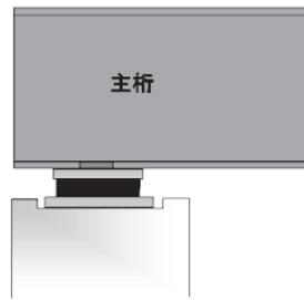
STEP-2：主桁ジャッキアップ・テフロン板設置
