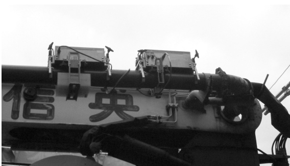
図-4 連続式コンクリート水分計（COARA）設置状況
