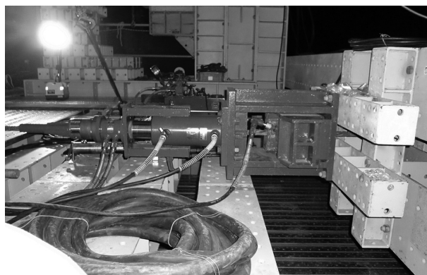
図-4 ダブルツイングジャッキ
