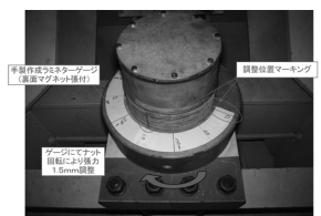
図-11 シム調整用角度定規
