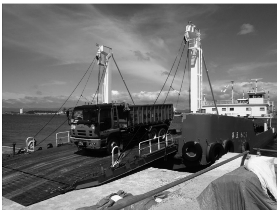
図-2 ランプウェイ台船による資機材搬入状況
