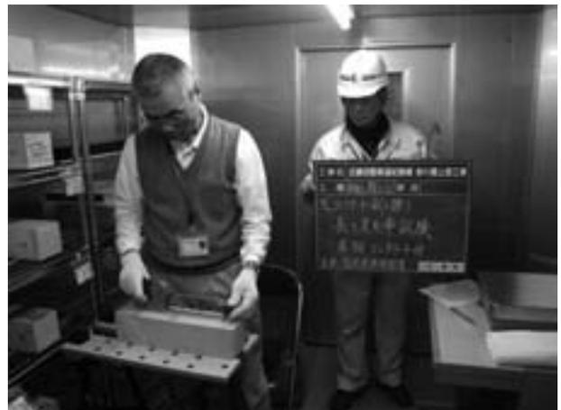
図-3 長さ変化率試験実施状況
