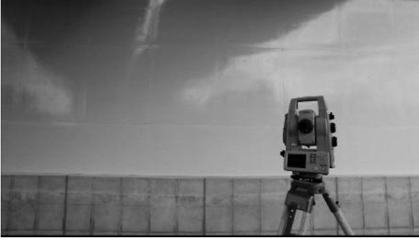
図-8 自動計測状況
