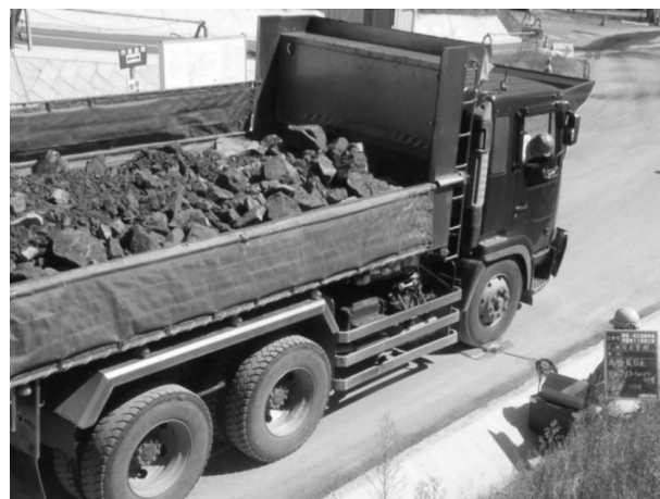
図-4 トラックスケールによる積載重量測定状況
