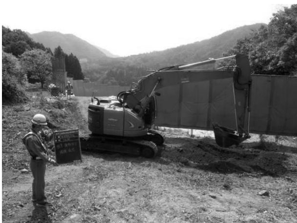
図-3 攪拌騒音試験実施状況
