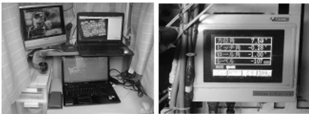
図-2 自動測量システム
