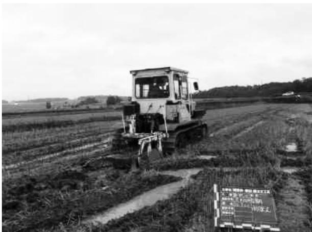
図-3 機械による水切り作業
